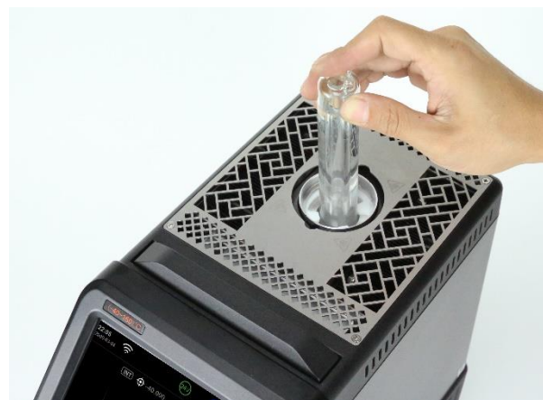
Mini TPW cell and Maintenance Apparatus
